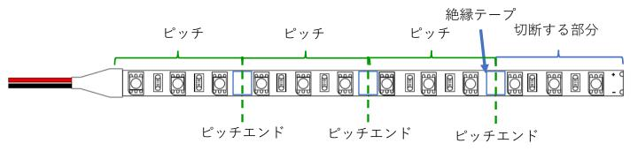
② 露出した銅の楕円部分の中心に縦に入っている細い線が切断箇所です。 よく注意してその線の上を丁寧にカットしてください。
