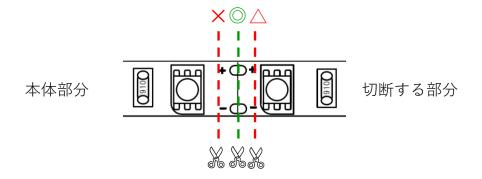
④ 最後に本体部分の切断箇所を絶縁処理(絶縁テープ、シリコーン樹脂等)して頂きます様、お願い致します。
